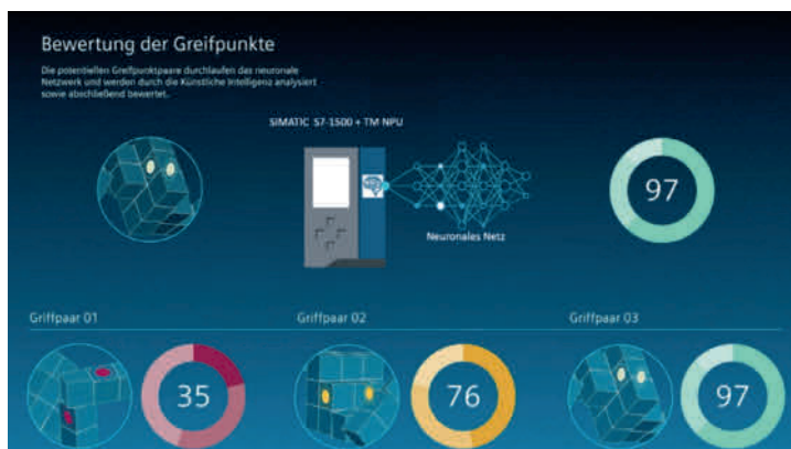
Abbildung 20: Die Neural Processing Unit in der Steuerung generiert Greifpunktpaare an senkrechten Flanken des Objektes und bewertet diese mithilfe eines Künstlichen Neuronales Netzes (Siemens AG)
