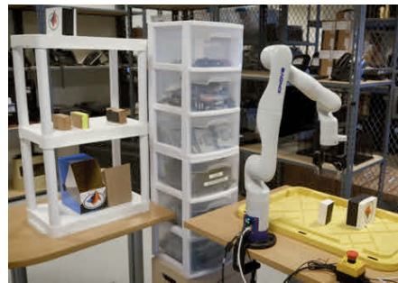
Abbildung 19: Ein Roboterarm wird mithilfe von KI-Methoden eingesetzt, um flexibel unterschiedliche Objekte in einem Lager zu detektieren und aufzugreifen (The MathWorks GmbH)
