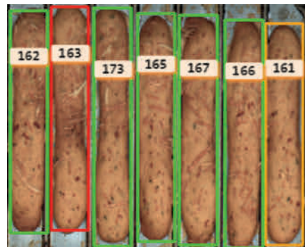
Abbildung 9: Backwarenprüfung mit MVTec HALCON und Deep Learning: Die Höhe der Bounding Box der detektierten Objekte dient als Maß für die Länge. Rot: Klassifiziert als zu starker Bräunungsgrad. Gelb: Klassifiziert als mit zu wenig Käse versehen (MVTec Software GmbH)
